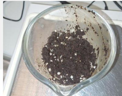
Figura 2. Mezcla de café húmedo con granza de plástico
